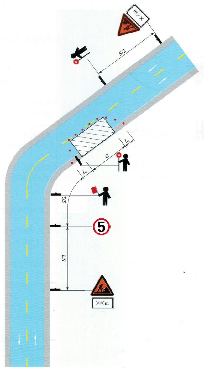
封闭单车道（弯道段）施工作业安全布置图
